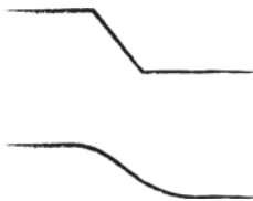
Teknisk skråning og s-formet kurve
